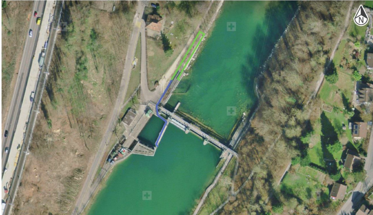
Abbildung 3: Neubau und Bestandssanierung des bestehenden Fischpasses als Vertikal-Schlitz-Pass (VSP) mit neuer Linienführung (grün: Neubau VSP mit mindestens einem Einstieg, blau: Freispiegelgerinne in der bestehenden Bausubstanz) [2]
